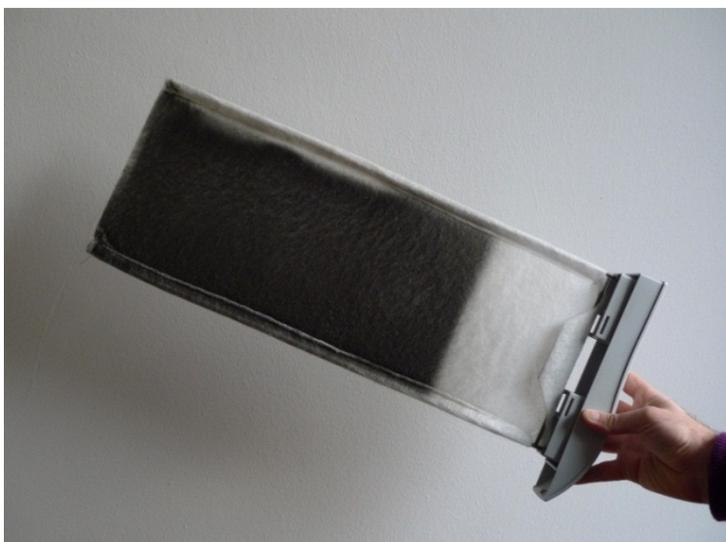
Il filtro dell'aria in ingresso dopo 20 giorni di funzionamento dell'impianto VMC.
