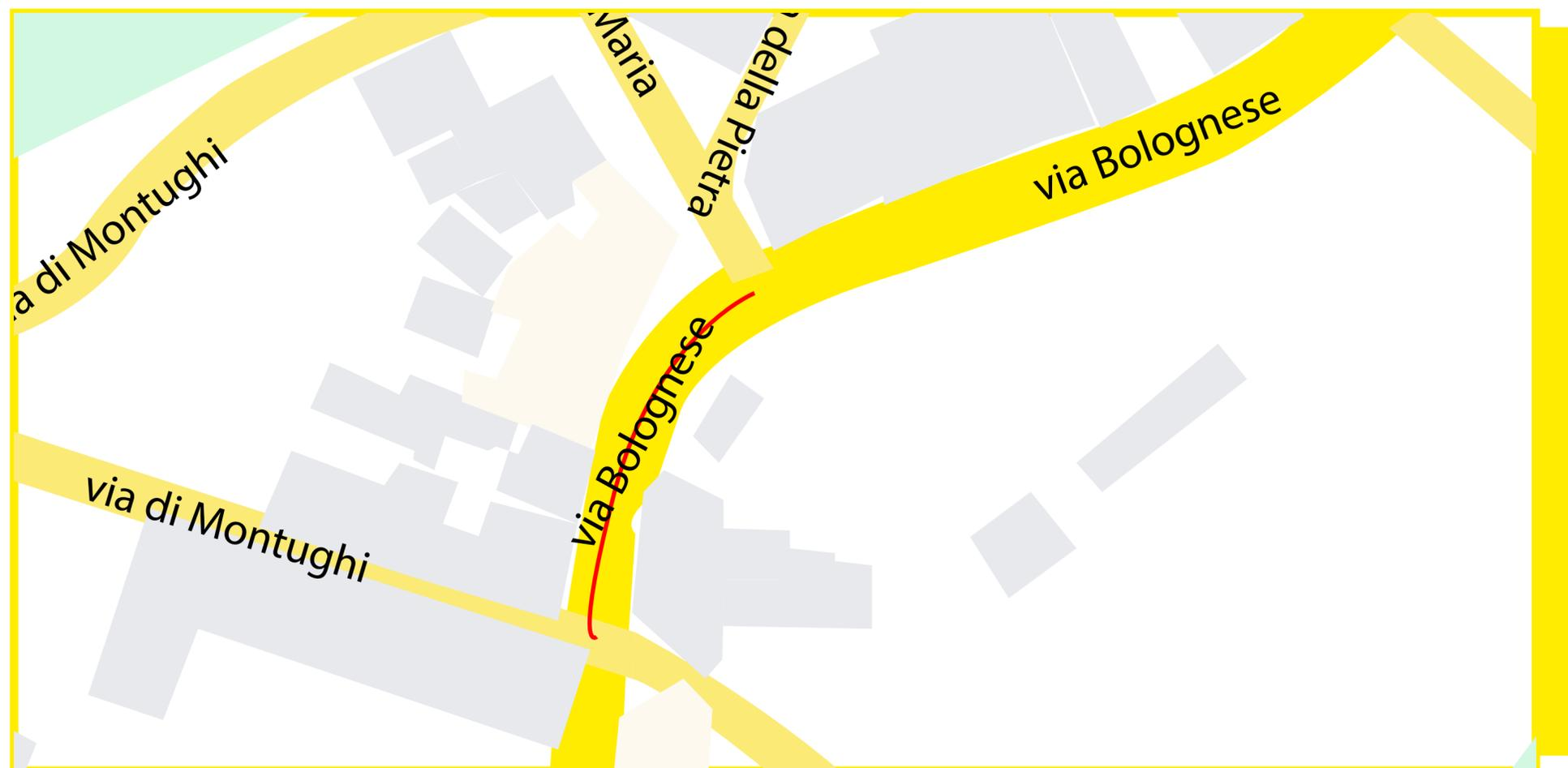
Oggetto dell'intervento è il tratto di **via Bolognese** da via di Montughi a via della Pietra (circa 50 metri). Il lavoro sarà organizzato su due turni (dalle 6.00 alle 14.00 e dalle 14.00 alle 22.00). È prevista la sostituzione della rete idrica di adduzione (diametro di 300 mm) e distribuzione (diametro di 100 mm).
